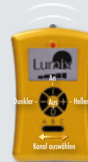
Abb. 6 Ein- oder Ausschalttaste drücken, Signal wird durch rot leuchtende LED angezeigt.
